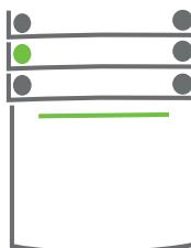
1. Når du går inn i bygningen (aktiverer en detektor med en „Forsinket sone“-reaksjon), vil systemet indikere inngangstiden med en kontinuerlig lyd og ved at en grønn segmenttast blinker der den forsinkede inngangen er utløst.
