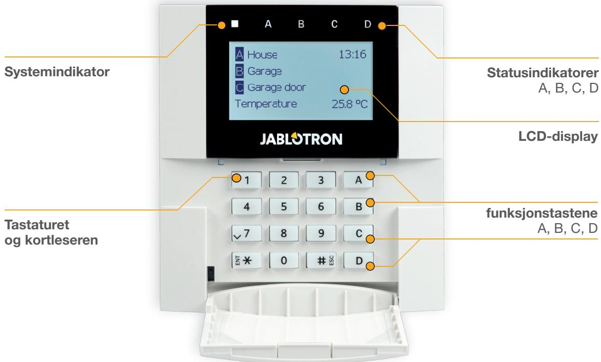
Statuser for enkeltområder vises ved hjelp av statusindikatorene A, B, C, D over LCD-displayet og ved hjelp av funksjonstastene. Alarmsentralen kan betjenes direkte (ved å til/frakoble og andre automatiseringsfunksjoner), med funksjonstaster på tastaturet. Funksjonstastene og statusindikatorene A, B, C, D er utstyrt med fargerik bakgrunnssupplysing for å tydelig vise områdets status.
